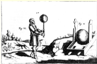
Reibungselektriermaschine von O. von Guericke
